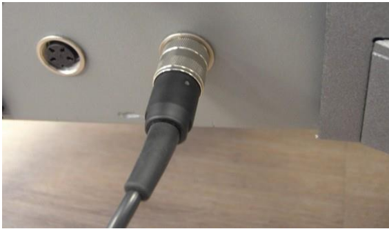
Figure 3-26. Câble de l'interrupteur à pédale gauche connecté
