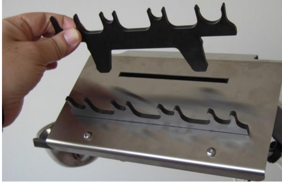
Figure 3-16. Insertion du support supérieur de pièce à main
