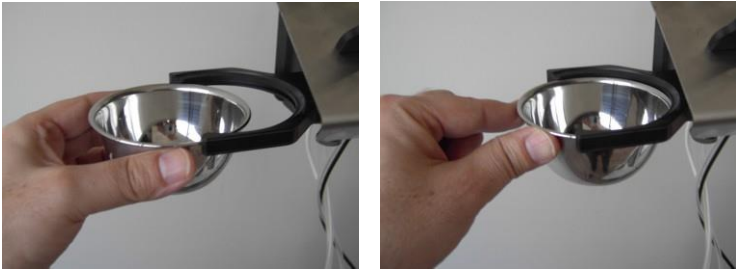
Figure 3-21. Insertion du gobelet dans le porte-gobelet
