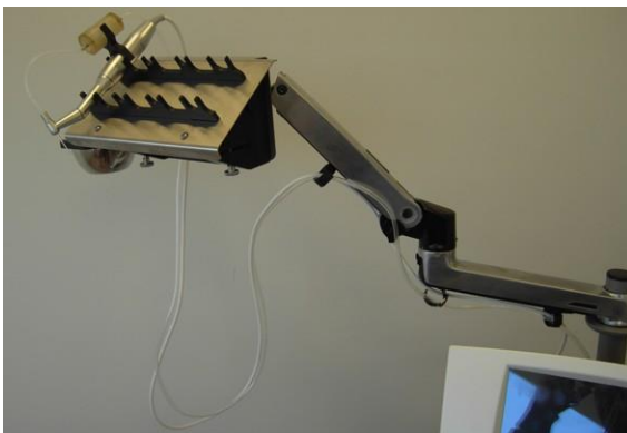
Figure 3-66. Câble et tubulure de pièce à main d'extraction inséré dans les supports de câble/tuyau du bras articulé
