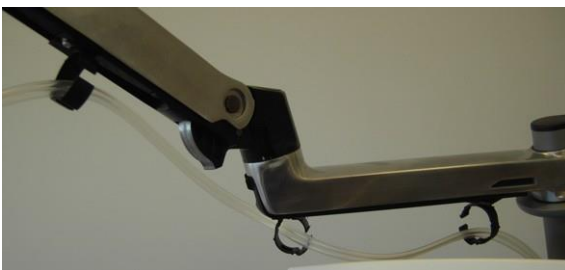
Figure 3-91. Tubulure de pièce à main d'implantation insérée dans les supports de câble/tuyau du bras articulé
