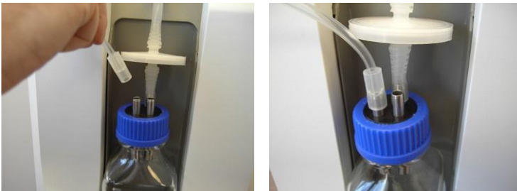
Figure 3-61. Raccordement du tuyau d'extraction au bocal
