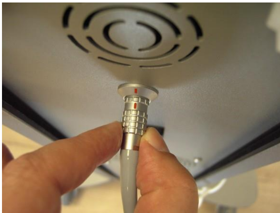
Figure 3-46. Branchement du connecteur du câble de la pièce à main
