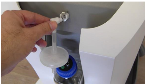
Figure 3-41. Raccordement du connecteur rapide de l'ensemble du filtre au port d'aspiration du système
