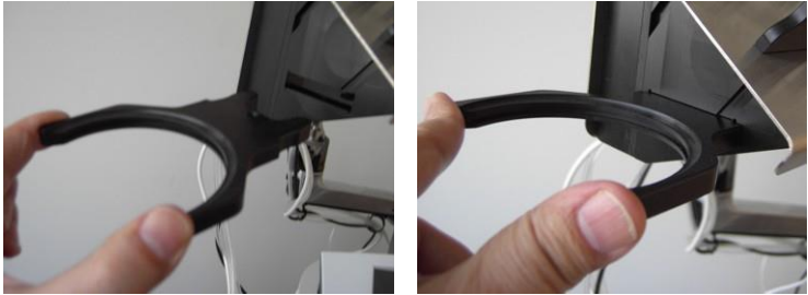
Figure 3-19. Insertion du porte-gobelet dans son logement
