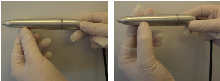
Figure 3-73. Vissage du corps de la pièce à main sur la base de la pièce à main
