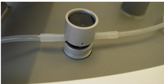
Figure 3-90. Tuyau d'implantation inséré dans l'électrovanne de droite
