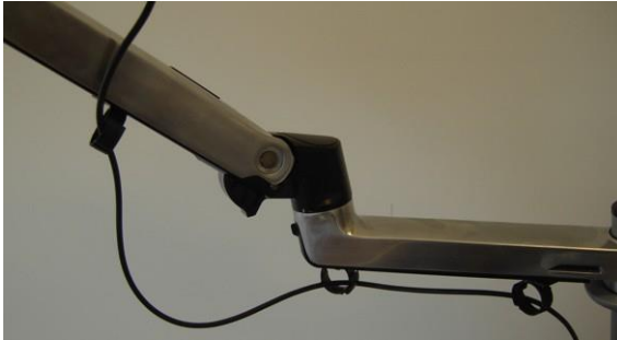
Figure 3-77. Câble de pièce à main d'incision inséré dans les supports de câble/tuyau du bras articulé
