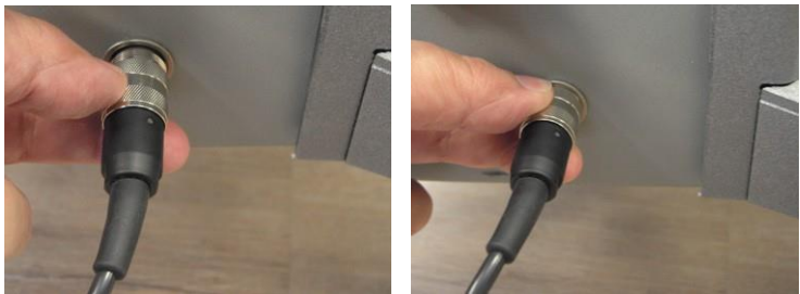
Figure 3-25. Raccordement du câble de l'interrupteur à pédale gauche à son connecteur, situé à l'arrière du système
